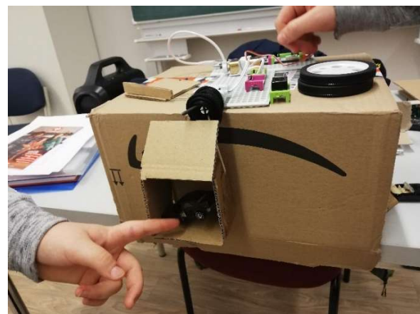
Bau einer Seilwinde zum Ziehen und Heben von Lasten: Verunfallte Fahrzeuge können so in Abhängen gesichert und bewegt werden.
