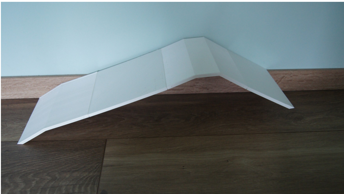
Abbildung 18: Im 3D Druckverfahren erstelltes Deichmodell (C. Weise)
