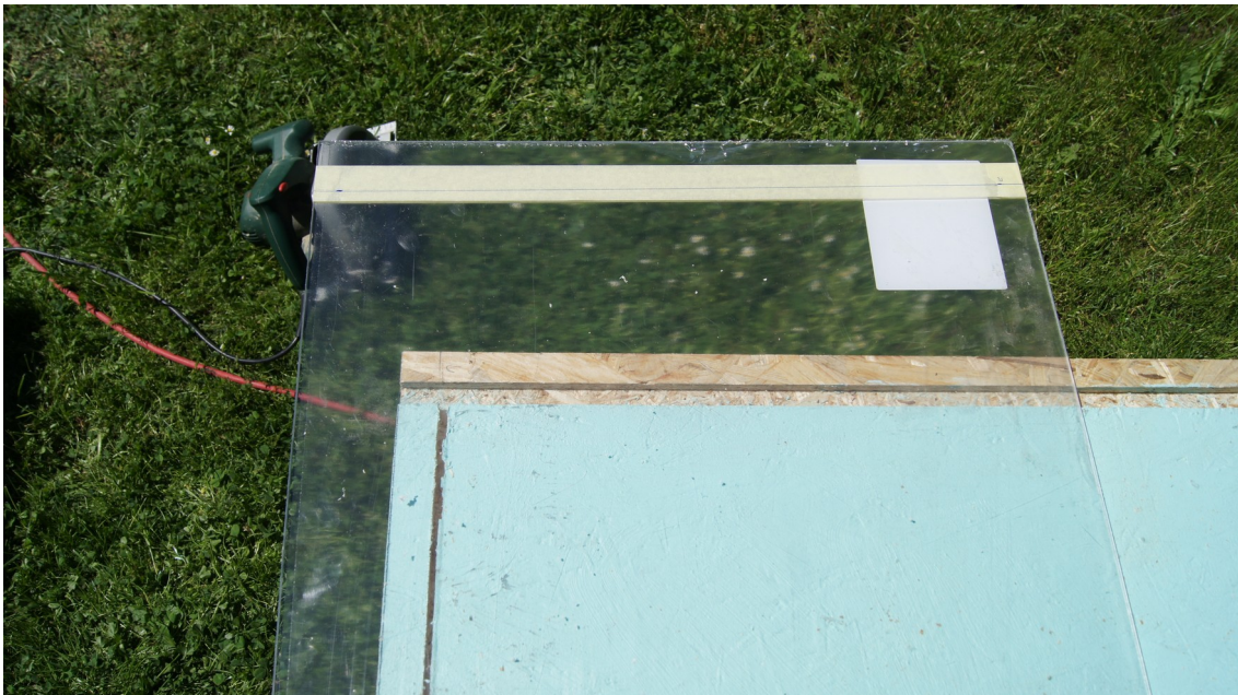
Abbildung 29: Abgeklebte Schnittfläche auf der Polystyrolplatte (C. Weise)
