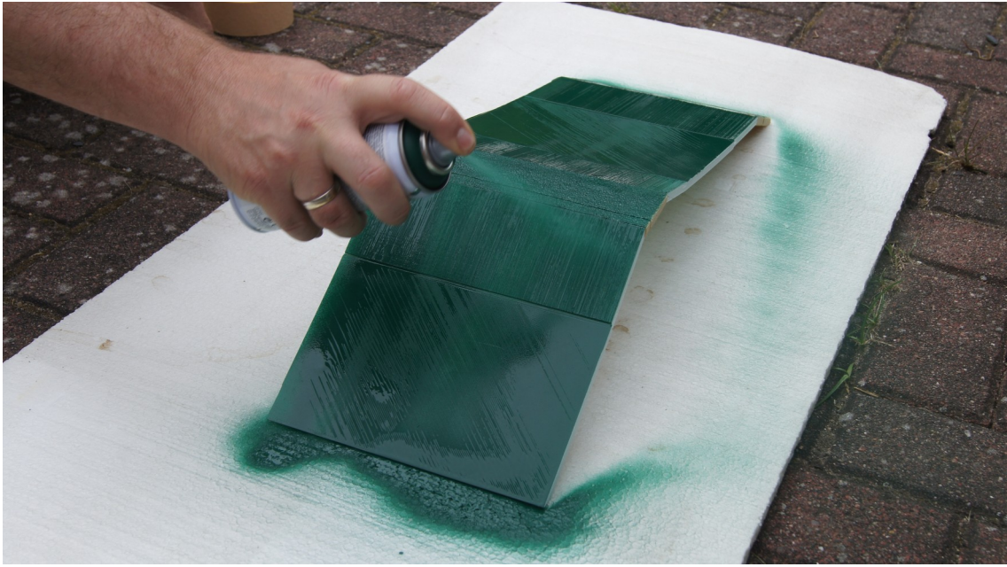
Abbildung 19: Lackieren des Modells (T. Weise)
