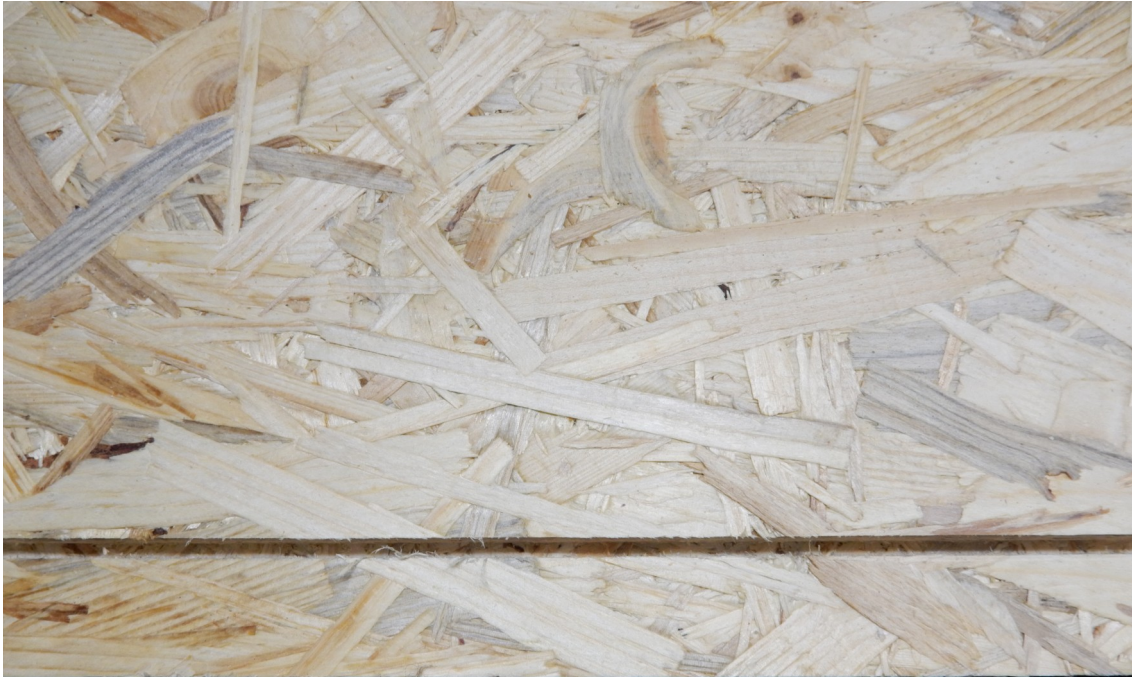
Abbildung 24: Fertige Nut als Aufnahme für die Polystyrolplatten (C.Weise)
