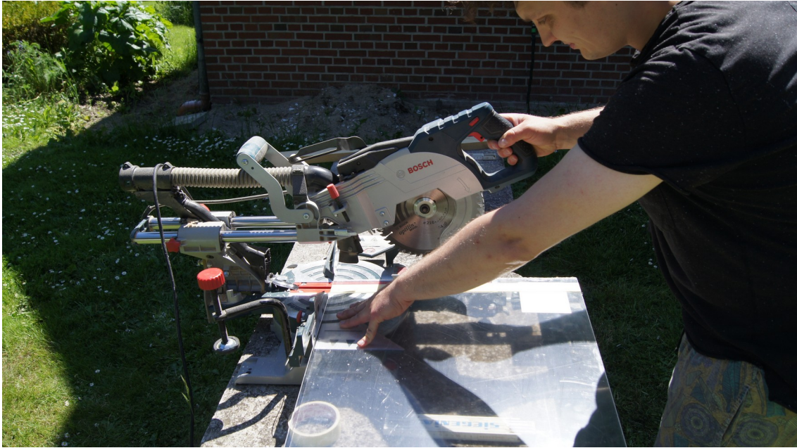
Abbildung 30: Zusägen der Polystyrolplatte (C. Weise)
