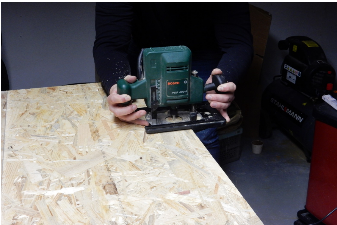
Abbildung 23: Einfräsen der Nuten mit dem Nutfräßer (C. Weise)
