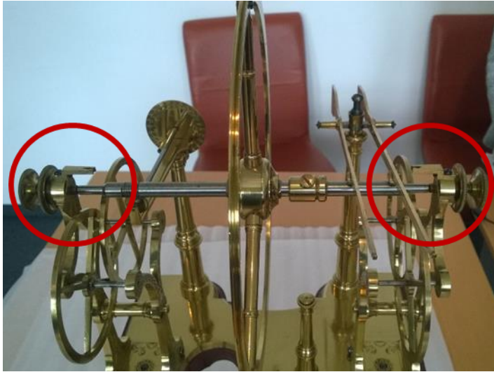
Fig. 5 Metallplättchen mit Bohrung und Schlitz. Quelle: Deutsches Museum © Andrea Grimm.
